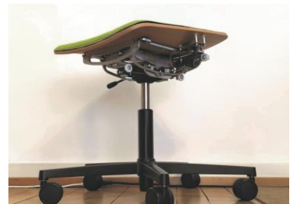
Modifizierter Stuhl mit eingebauter Elektronik, die auf der rechten Seite sichtbar ist. Die Elektronik enthält einen Beschleunigungssensor zur Erfassung der Bewegung der Sitzplatte.
