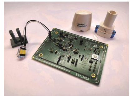
Konzeptaufbau Batterielose Datenerfassung für Medical Devices
