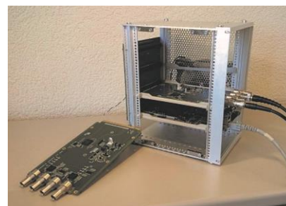
Das Rack mit dem Multimedia- Prozessor und der Platine
