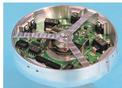
Der Motorcontroller wurde in kompaktem Formfaktor entwickelt. Die Abbildung zeigt die Leistungselektronik und den optischen Positionsgeber eingebaut im gefrästen Aluminiumgehäuse.
