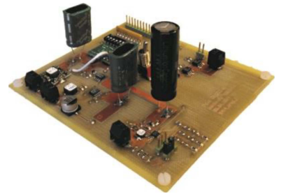
Die Grafik oben zeigt den realisierten Print mit drei verschiedenen Boosterschaltungen zur Ansteuerung eines Stellmotors.
