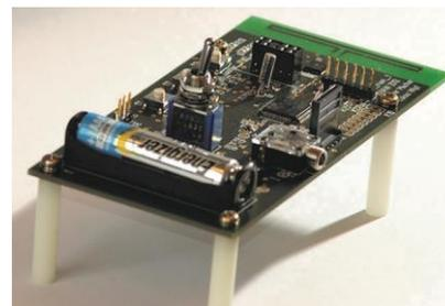
Der entwickelte Print, welcher mit einer einzigen AAA Batterie betrieben werden kann.
