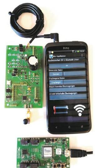
Das Smartphone kommuniziert über den Audio Jack mit dem eigens entwickelten Print. Dieser stellt eine Funkverbindung über Bluetooth Smart mit dem Evaluations Board her.
