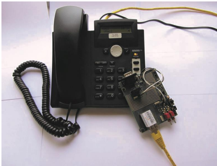
Der embedded Webserver XPort Pro und ein VoIP-Telefon
