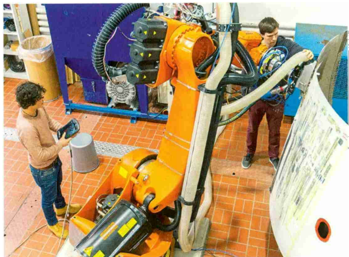
Der Roboter wird bei diesem Lackentfernungssystem als intelligentes Werkzeug eingesetzt.
