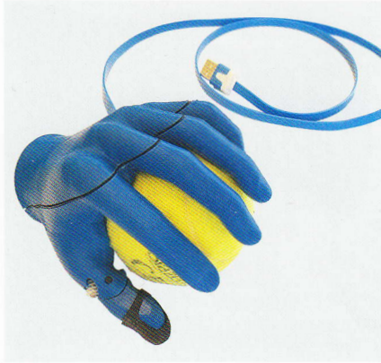
▲ Der aktuelle Prototyp der Prothesenlösung mit beweglich gestaltetem Daumen.
