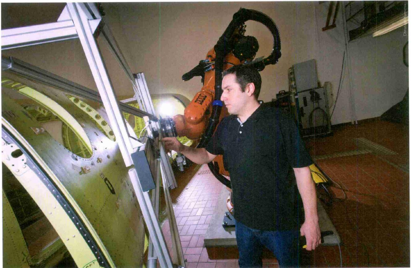
Mensch-Roboter-Kooperation bei der Rumpfmontage eines PC-12 – volles Vertrauen in die sichere Robotertechnologie.
