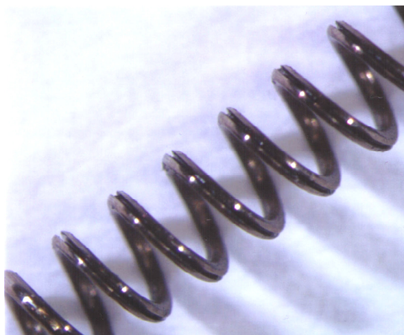
Abbildung 8: Lichtmikroskopaufnahme der Helixnadel mit erodierter 0,08 mm-Kerbe.
