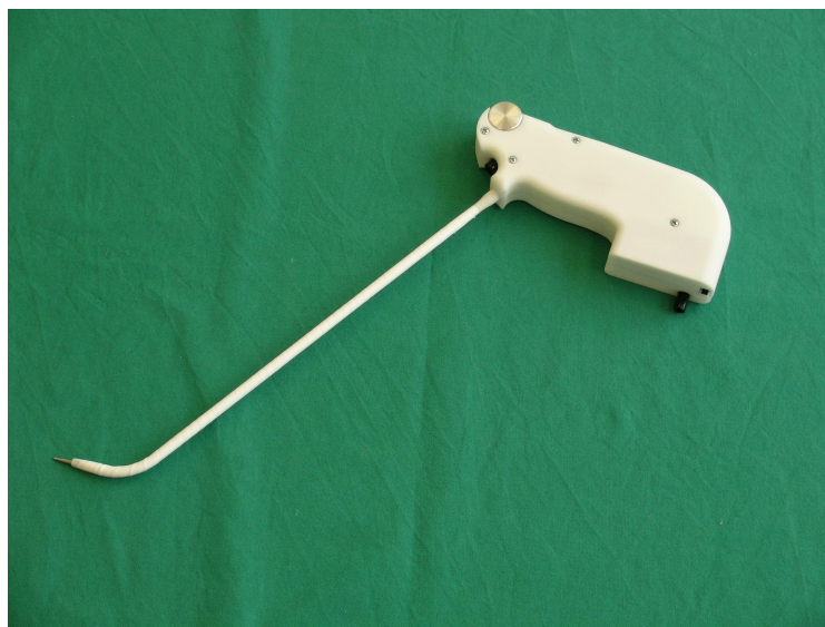
Abbildung 17: Elektrisches Antriebsmodul mit Geschwindigkeits- und Momentenregelung
