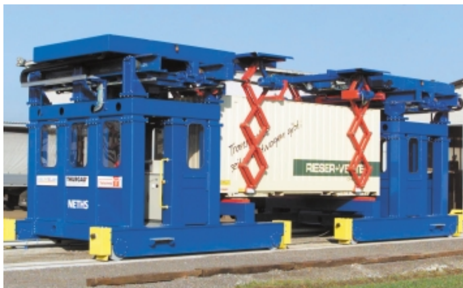
Das entwickelte System für den horizontalen Umschlag von ISO-Container und Wechselbehälter unter der Fahrleitung beim Umladen. (Bild 1)
