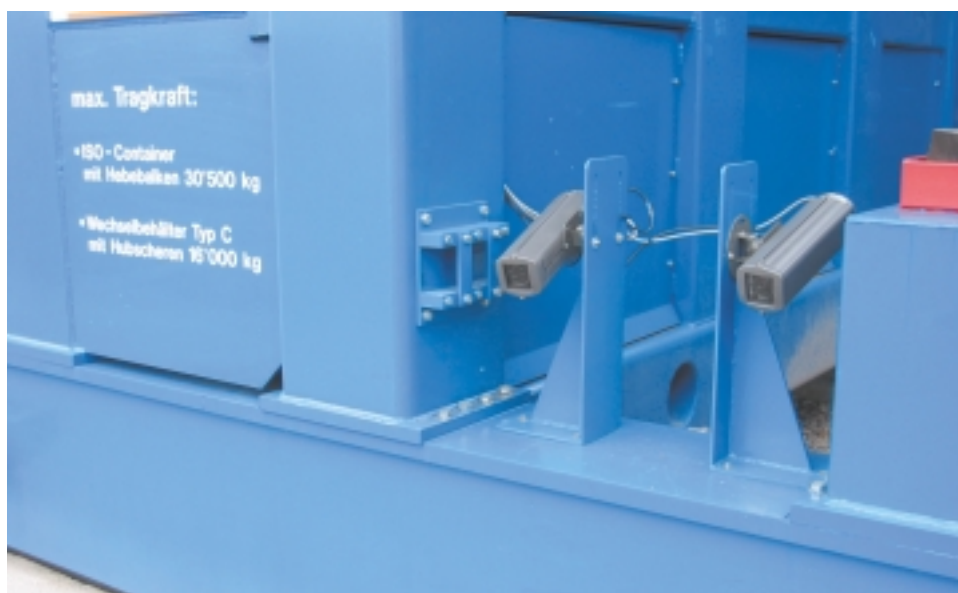
Die beiden Kameras des Vision-Systems für die Detektion der Containerbeschläge mit 3D-Bildauswertung. (Bild 2)
