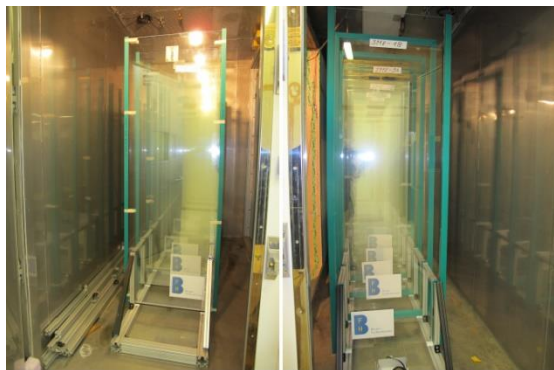
Verklebte Elemente in der Klimakammer
