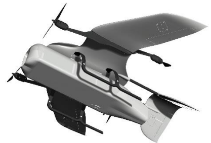
Die Schwenkmotoren sorgen für den Schub im Streckenflug
