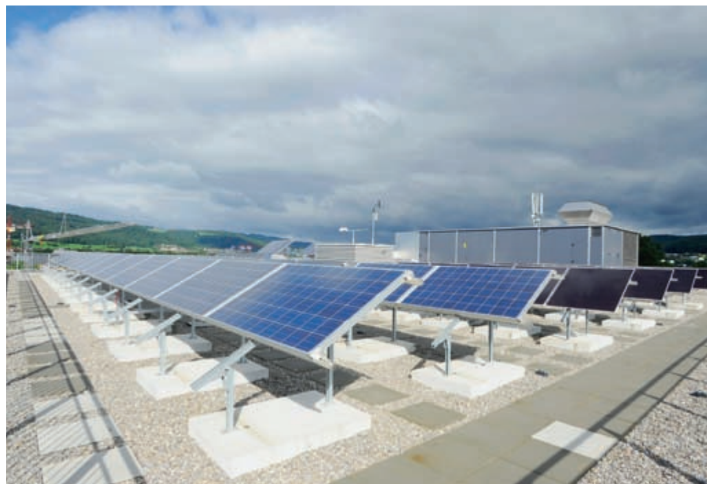
Bild 1 Fünf verschiedene Solarmoduletechnologien werden in Dietikon getestet: polykristallines Silizium, Silizium-HIT, Dünnschicht uc-Si/a-Si, Dünnschicht-CIS und Dünnschicht-CdTe.
