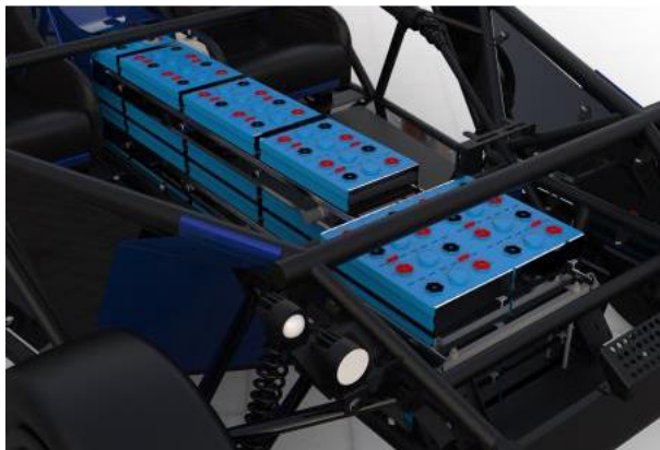
Das Batteriesystem des eRod.
