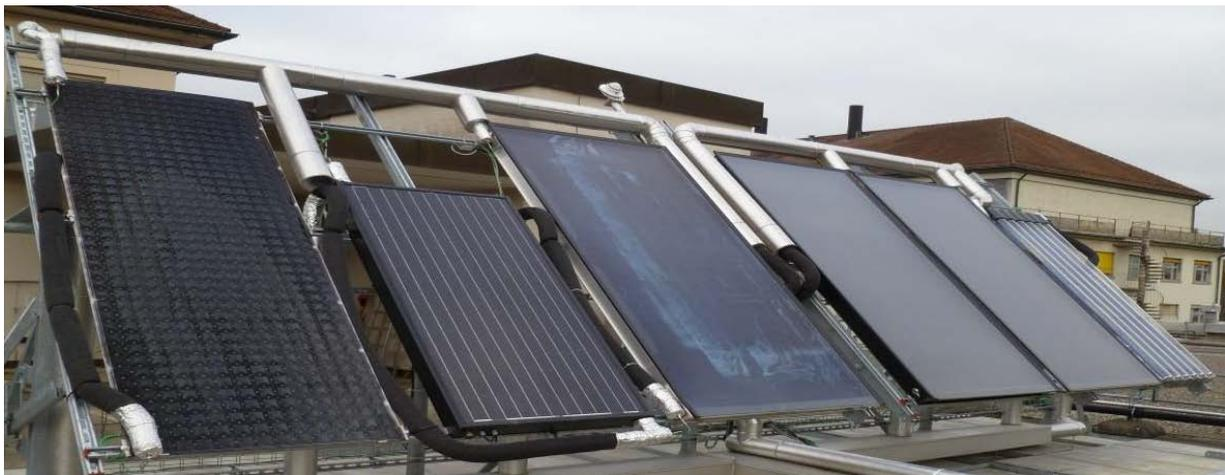
Die Solarthermieanlage wird für die studentische Ausbildung sowie für Forschungs- und Entwicklungsarbeiten genutzt. Auf einem Kollektorträger können bis zu 6 Kollektoren angebracht werden. Der Kollektorträger befindet sich auf dem Dach des Institutsgebäudes, ist nach Süden ausgerichtet und kann beliebig im Anstellwinkel verändert werden. Jeder Kollektor besitzt separate Zuleitungen wodurch ein unabhängiger Betrieb der Kollektoren gegeben ist.
