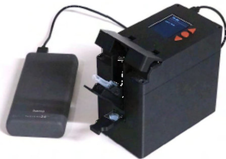
Abb. 1: Prototyp des Point-of-Care-Testgeräts zur Quantifizierung und Überwachung des Ammoniakgehalts im Blut unter Verwendung des von Versantis entwickelten Assays.
