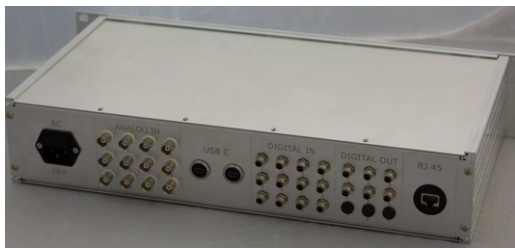
Abb. 1: Prototyp des Digital Wolfram-Datenloggers, geschützt durch ein stabiles Metallgehäuse.
