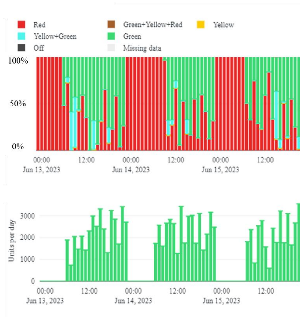
Abbildung 25: Dashboard Darstellung mit Ampelstatus und berechnetem Produktionsausstoss.
