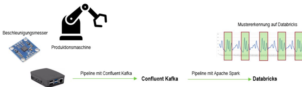
Abbildung 1: Prozessschema für initiales Projekt.
