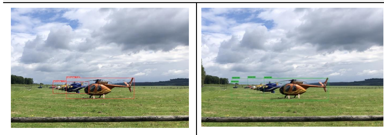
Von den sechs nahe beieinander liegenden Helikoptern erkennt YOLO nur zwei und DETR vier. Allerdings sind die vorhergesagten Bounding Boxes bei beiden Modellen sehr ungenau.
