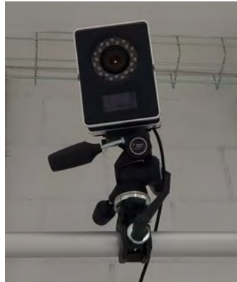
Abbildung 2.2.: Eine Kamera des Motion Capture Systems Vantage der Firma Vicon
