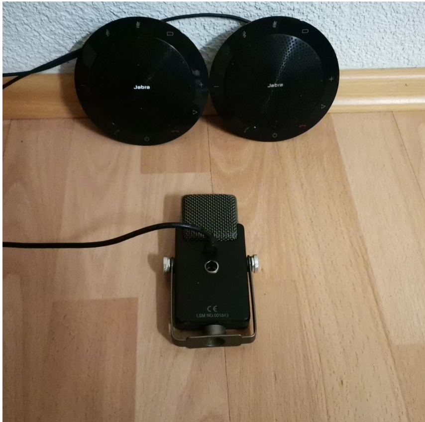
Abbildung B.1.: Aufbau für die Experimente der Variante 1 “abspielen und erneut aufnehmen”. Im Hintergrund sind die beiden Freisprechanlagen von Jabra zu sehen, die als Lautsprecher dienen.
