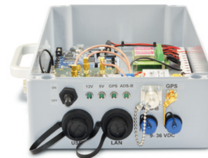
Das mobile Ortungssystem im Koffer mit Aufstellantenne ist leicht zu transportieren.
