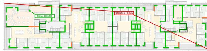
Abb. 3: Tragsystem Erdgeschoss
