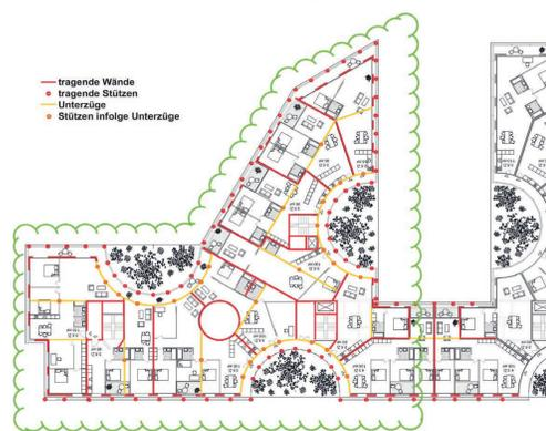
Abbildung 3: mögliche tragende Struktur im festgelegten Perimeter
