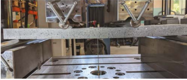
Bild 2 Rissbild einer 40 mm CPC-Platte im Vierpunktbiegeversuch kurz vor dem Versagen Crack pattern of a 40 mm CPC Slab during four-point bending testing, shortly before failure occurs
