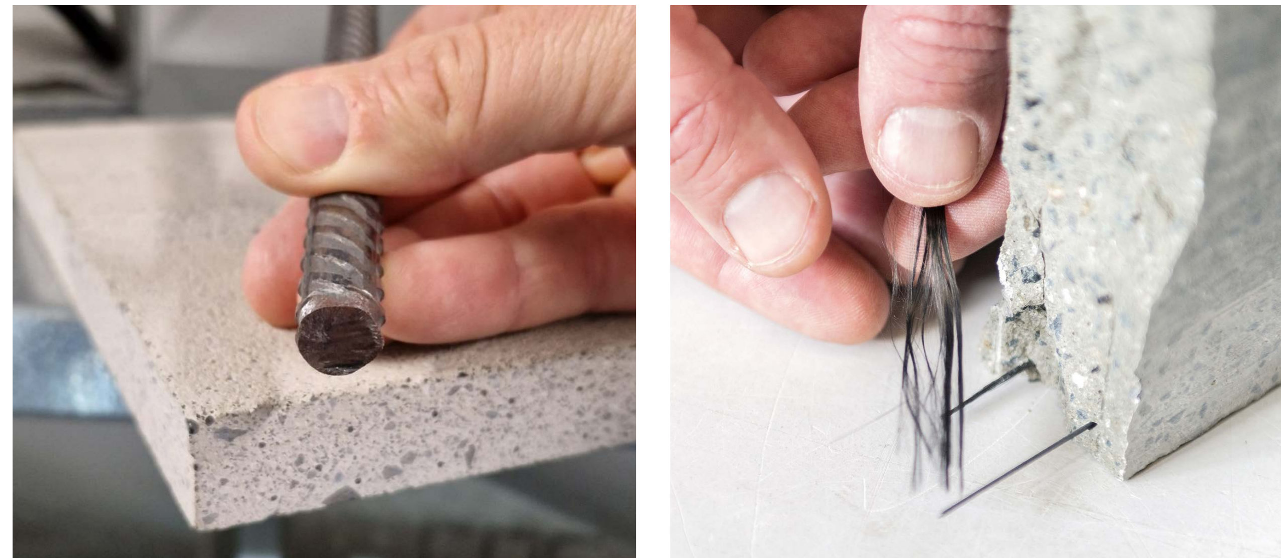
Vergleich Bewehrungsstahl mit Carbondraht
