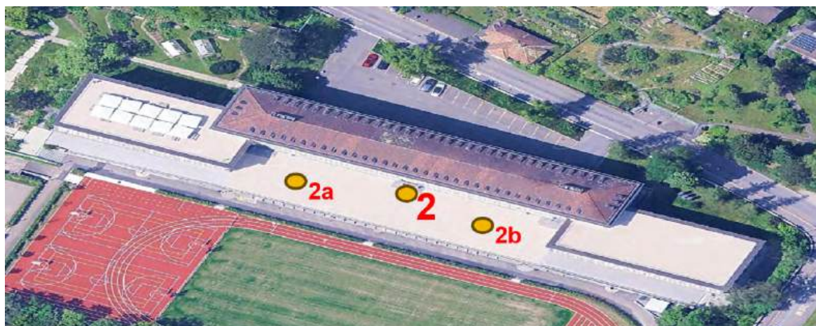
50 - In der CFD-Analyse definierte Knotenpunkte zur Messung des Einflusses der Aussenverschattung auf die Lufttemperatur.
