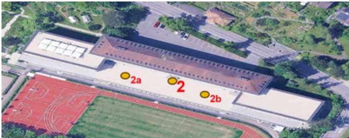
50 - In der CFD-Analyse definierte Knotenpunkte zur Messung des Einflusses der Aussenverschattung auf die Lufttemperatur.
