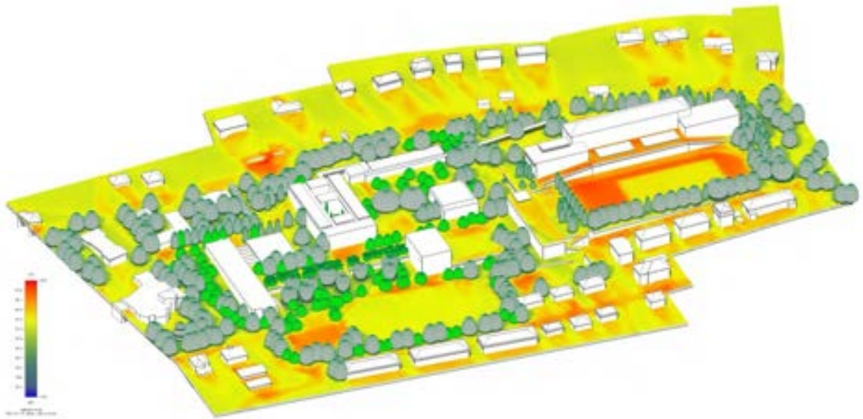
28 - Isometrieansicht BIM-Modell "Platine" Planung mit PET-Analyseresultat
