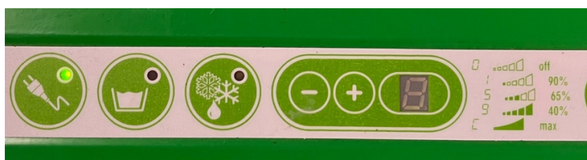
Abbildung 16: Bedienungsfläche eines Luftentfeuchters
