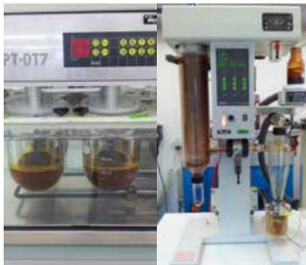
Abb. 2: links: Mazerationsgerät beim Mazerieren von 6 Versuchen mit unterschiedlicher Ethanolkonzentration; rechts: Sprühtrockner BÜCHI Mini Spray Dryer während der Sprühtrocknung des hergestellten Extrakts
