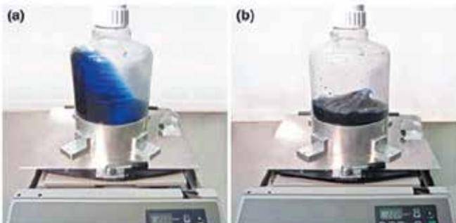
Abb.: Strömungsbewegung der Flüssigkeit in einem zylindrischem Einweg-Bioreaktor 10 L unter «in-phase» Bedingungen (a) und «out-of-phase» Bedingungen (b), (Klößner, Diederichs, *et al.*, 2013)
