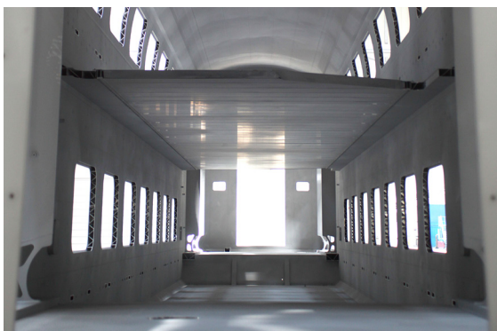
Wagenkasten in Integralbauweise Quelle: Stadler
