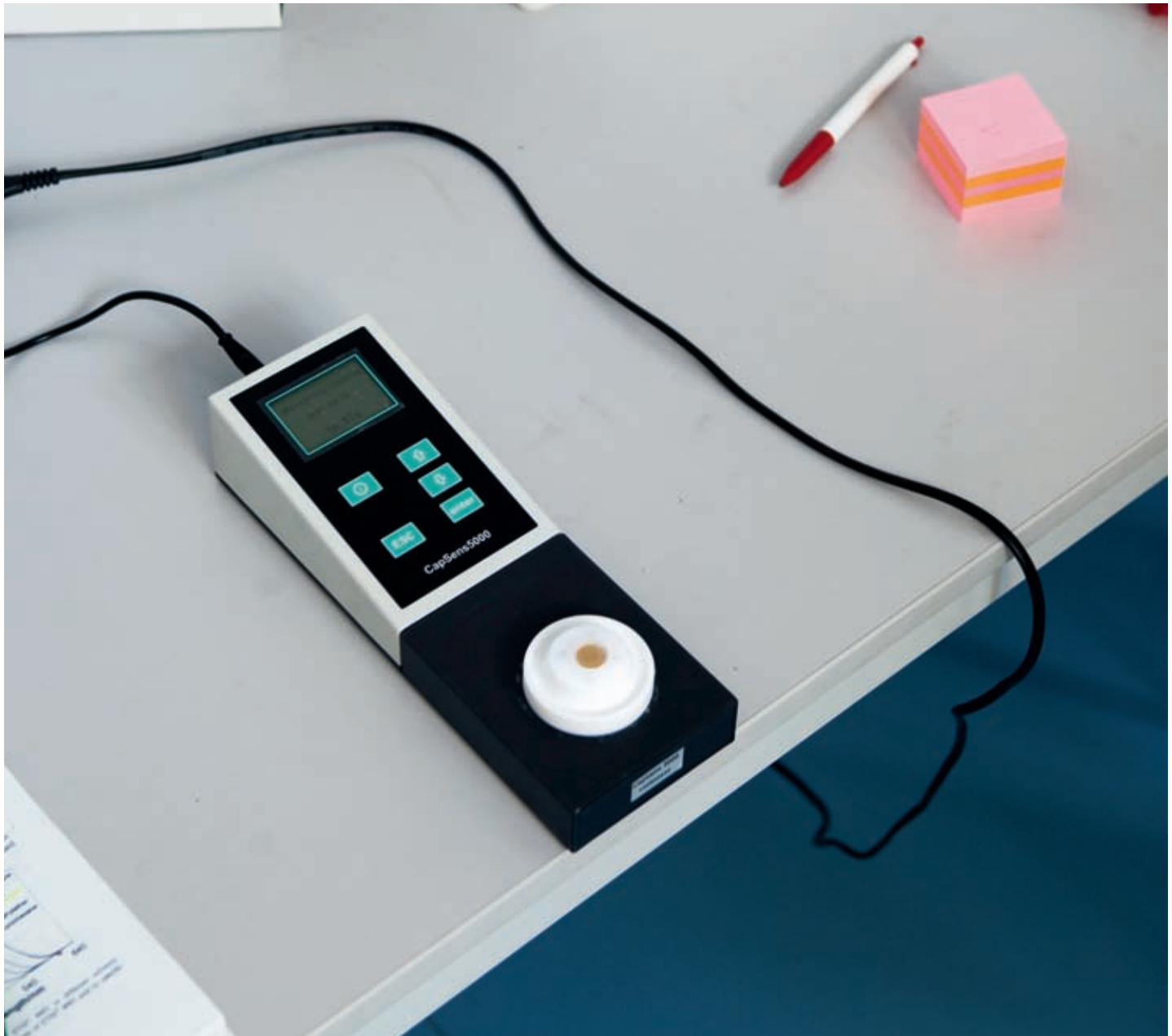
Mit dem Frittierölmessgerät «CapSens 5000» ist der Verschmutzungsgrad von Frittieröl ganz einfach festzustellen.
