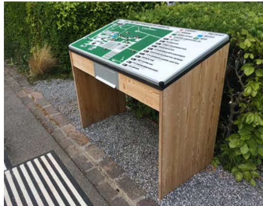
Taktiler Lageplan mit unterfahrbarem Unterbau
