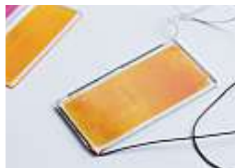
Neuartige Materialien sammeln das Licht und leiten es an eine Solarzelle weiter.
